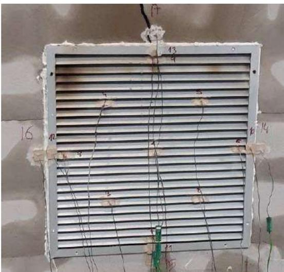
Apparence de l'échantillon vers la fin de l'essai.
