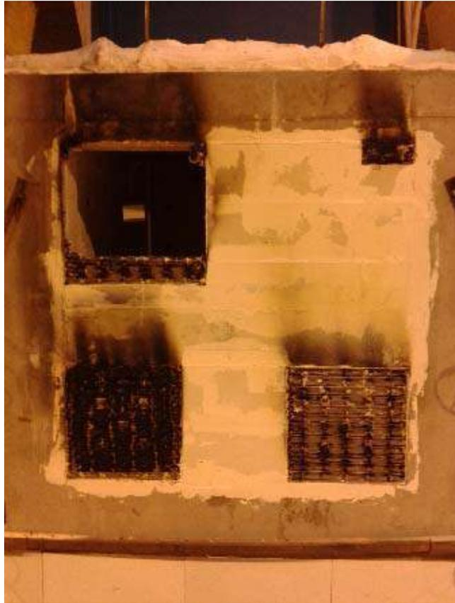
**Photo C** (haut) Face non exposée des éléments après essai et refroidissement.
