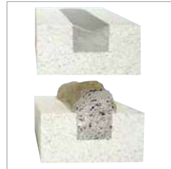
ACRYLODICE F avant et après exposition au feu.
